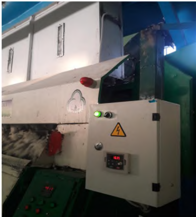
Рисунок 2. Автоматизированная система контроля и управления процессом пильного джинирования хлопка внедренной на Кизирикском хлопкозаводе
